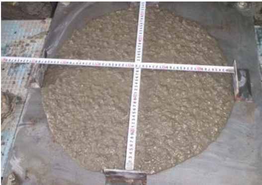
写真－3 中流動覆工コンクリート
