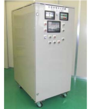
図-1 放電衝撃破砕工法のシステム
