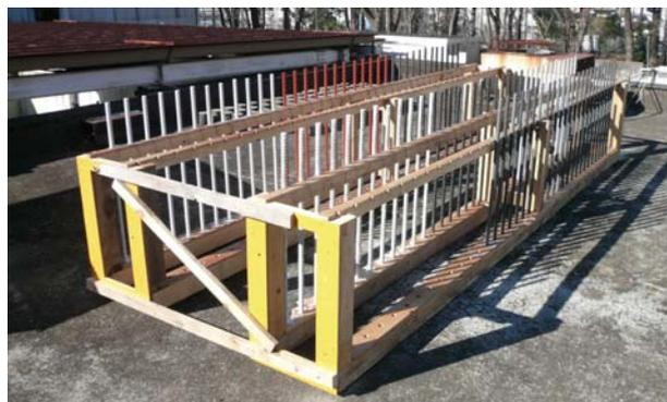
写真-1 鉄筋暴露状況
