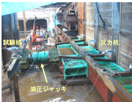
写真-2 水平載荷試験状況
