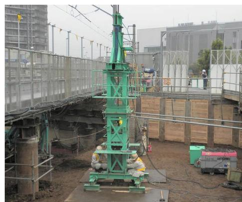
写真-1 急速載荷試験状況
