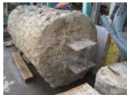
写真-4 改良体と芯材の密着状況 (No. I)
