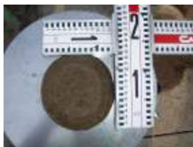
写真-1 テーブルフロー試験 (130×132 mm)
