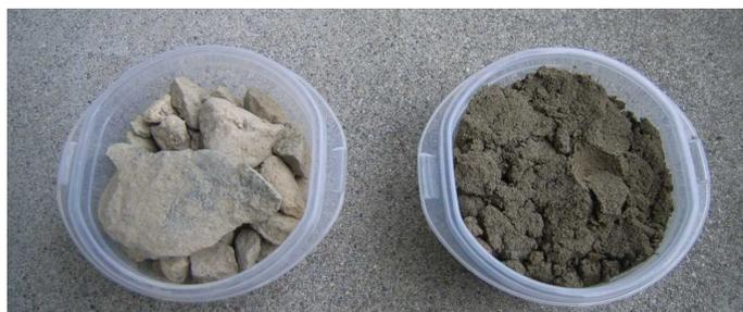
写真 2 掘削土(礫・粘性土)
