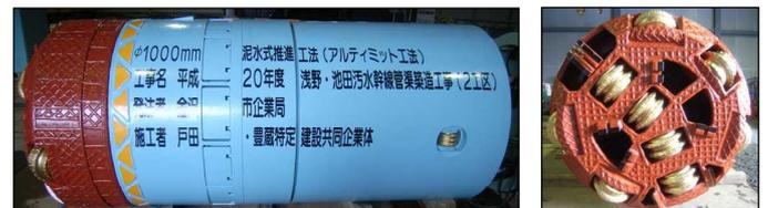
写真-1 泥水式掘進機
