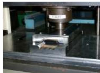
写真-1 圧縮試験状況
