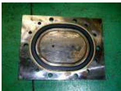
写真-3 耐水圧試験供試体
