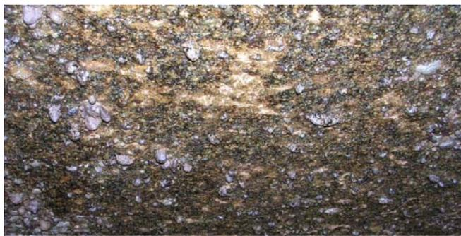
図-2 供試体の加熱後表面状況
