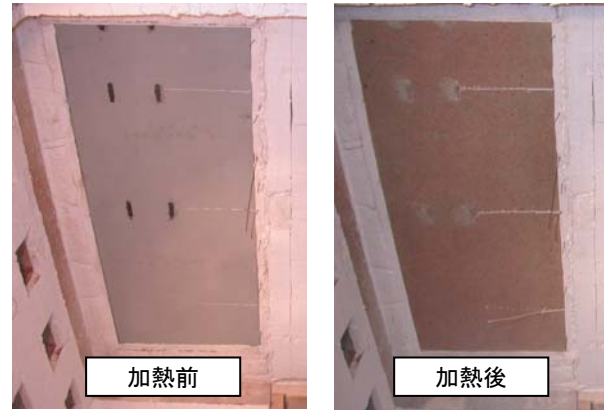
写真-1 試験体加熱面の状況
