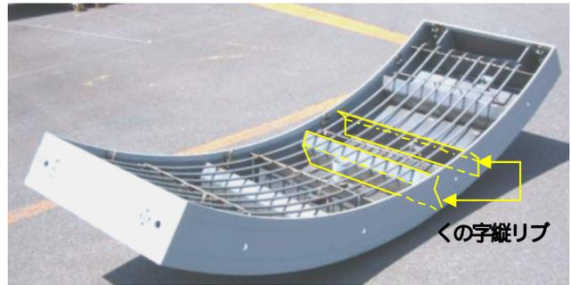
写真-1 セグメントの構造（打設前）
