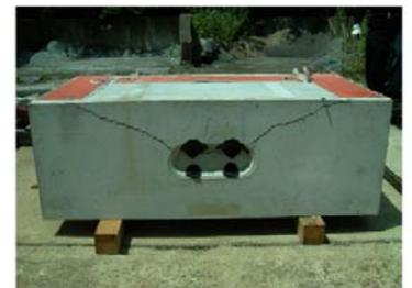
写真-2 せん断破壊状況
