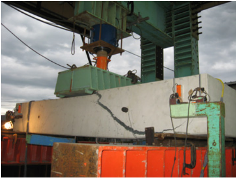
写真-3 せん断破壊状況
