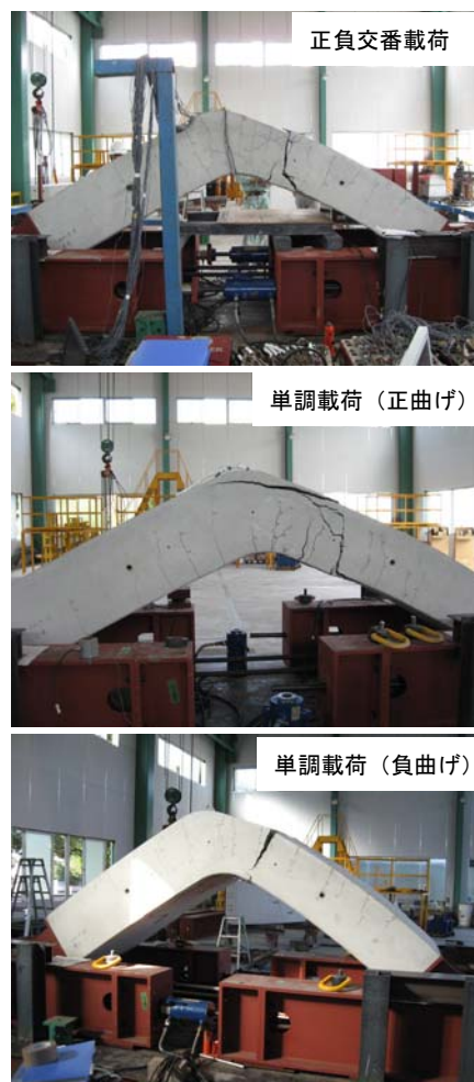
写真-1 破壊状況
