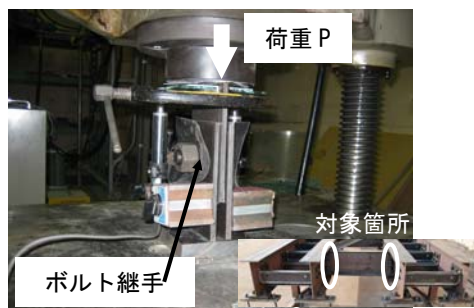
写真－３ ボルト継手せん断試験状況
