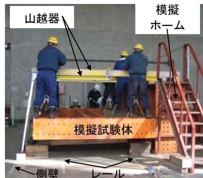
写真－２ 山越器耐力確認試験状況
