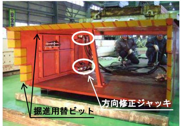
写真-1 エレメント推進方向修正機構
