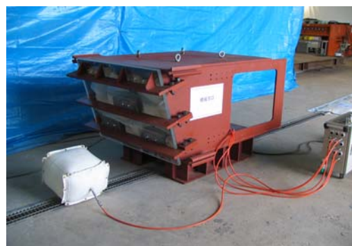
図6 切羽防護性能確認試験
