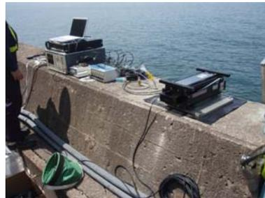
図-3 起振機による加振実験風景
