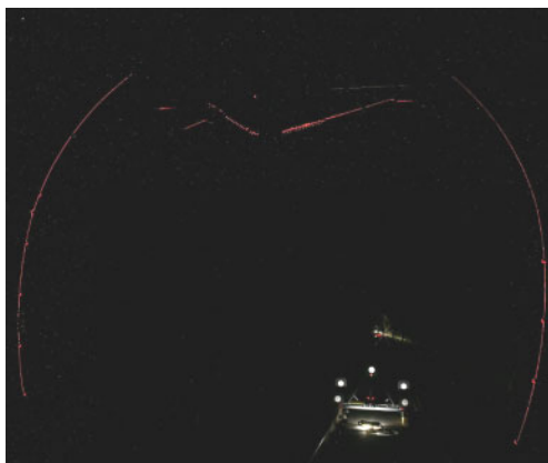
写真2 トンネル断面計測の一例
