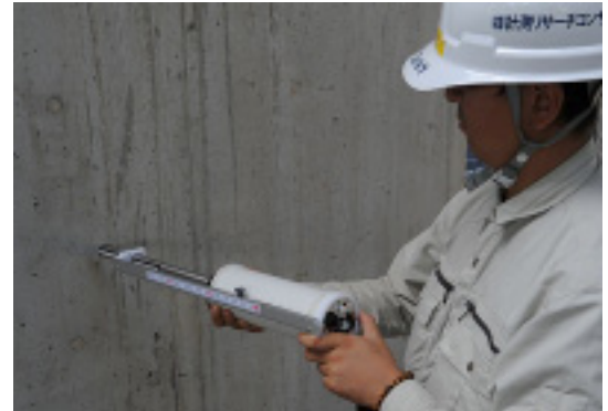
写真-1：棒形スキャナーによる調査状況
