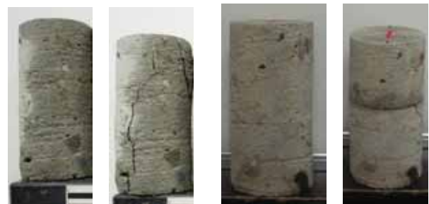
試験前 試験後 図-3 試験前後の供試体 (一軸圧縮試験)
