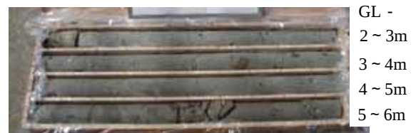
図-2 採取された改良体の一部
