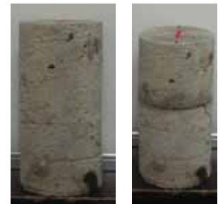
試験前 試験後 図-4 試験前後の供試体 (一面せん断試験)
