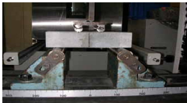
写真-1 繰り返し曲げ試験の実験状況
