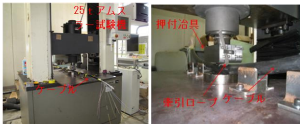
図-4 ケーブル側圧に対する光損失測定実験状況
