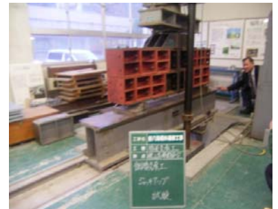
写真-3. 鋼製ブロック載荷試験
