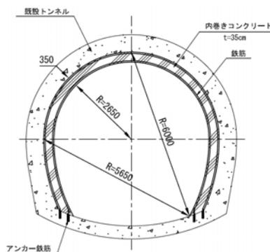
図-2 内巻き工断面図
