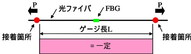
図 1 ロングゲージ FBG センサ図
