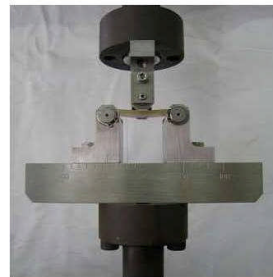
写真-3 3点曲げ疲労試験方法
