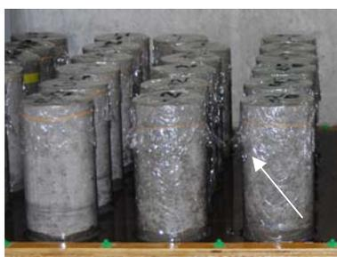
写真-1 供試体の吸水状況
