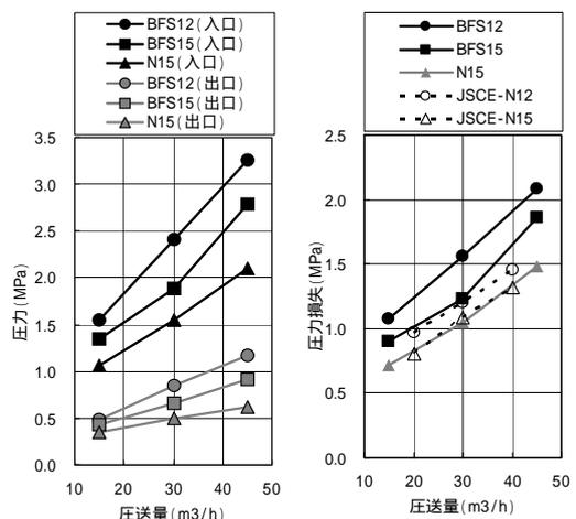
図 - 4 管内圧力と圧力損失
