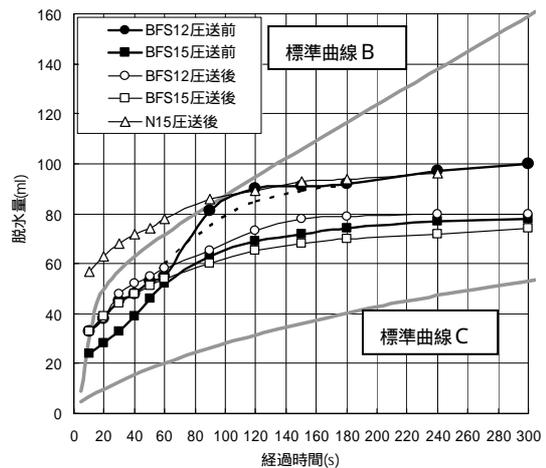
図 - 3 加圧脱水性状
