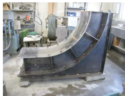
写真-1 模型型枠
