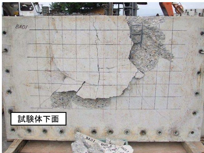
写真 2 BA 試験体破壊状況
