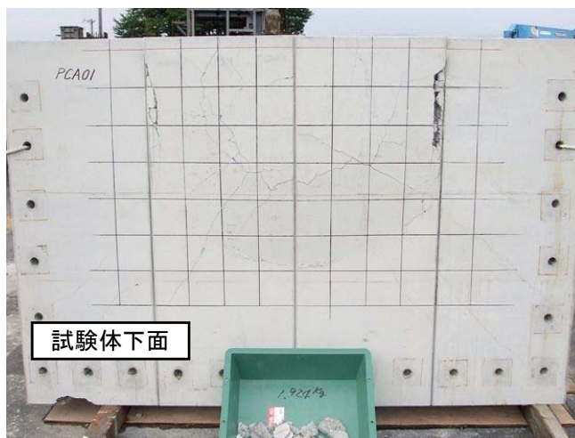
写真 3 PCA 試験体破壊状況
