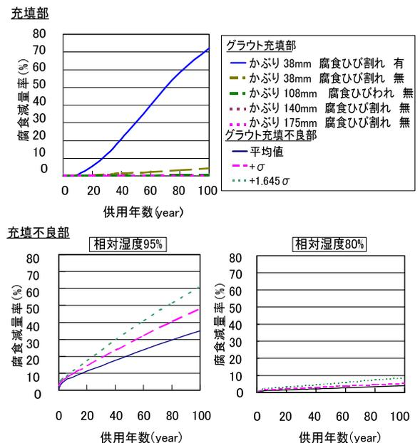
図-2 グラウト充填部とグラウト充填不良(気中)の比較
