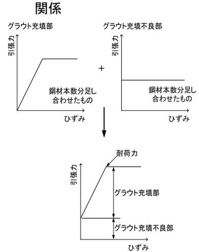
図-4 耐荷力へのグラウト充填不良部の考慮の方法
