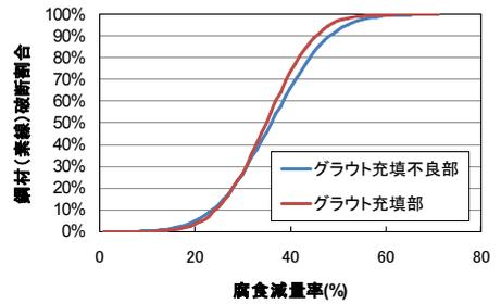
図-3 腐食減量率と鋼材破断割合の関係
