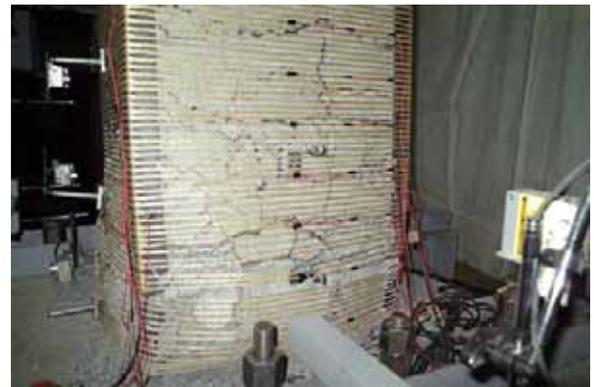
写真-1 供試体 No.2 実験終了後 (12 y1 サイクル目終了後)
