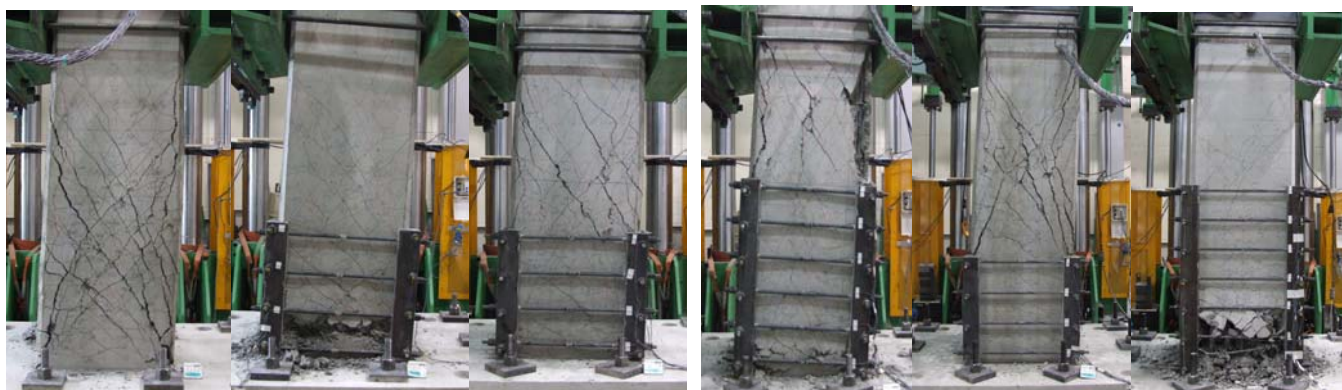
試験体 No. 1 (4 \delta y ) 試験体 No. 3 (10 \delta y ) 試験体 No. 6 (5 \delta y ) 試験体 No. 7 (7 \delta y ) 試験体 No. 8 (3 \delta y ) 試験体 No. 9 (10 \delta y )
