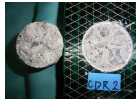
図-6 破壊状況の様子(炭素繊維)
