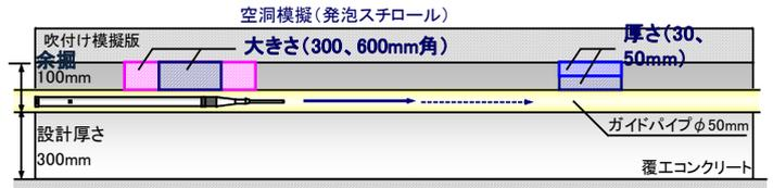
図 3-2 トンネル天端アーチ部模擬試験体
