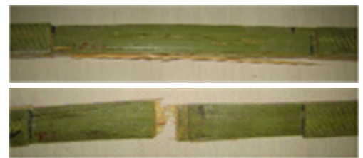
図 3 破壊形式(上: 繊維破壊; 下: 節部破断)
