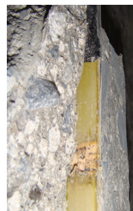
図8 破壊形式(右:鉄筋コンクリート部支左:竹材節部支圧)
