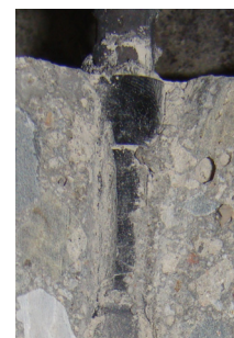
図8 破壊形式(右:鉄筋コンクリート部支左:竹材節部支圧)
