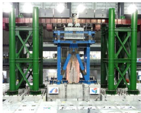
図-1 実規模橋梁耐震実験の状況 (E-Defense)
