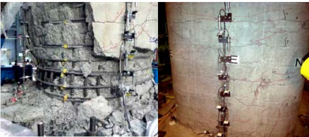
左:普通コンクリート 右:高じん性繊維補強モルタル 図-6 実規模橋脚基部の破壊形態の比較
