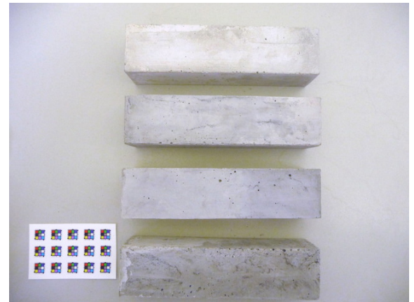
図-2 ナノカーボン添加モルタル供試体 (上から 0.0, 0.1, 0.2, 0.3 vol%)
