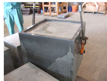
図5 埋設型枠を用いたガラ先充填 再生コンクリートブロック
