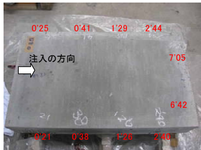
図-1(a) 低粘度エポキシ樹脂の注入特性
