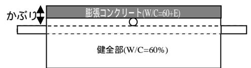
図2 劣化模擬供試体の概要
