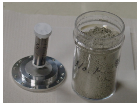
図2 セメント試料とバナジウム性容器
