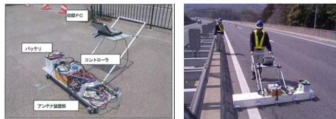
図 3.3.1 多配列レーダシステムの概要
