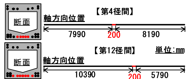
図-4 PCストランドの破断のモデル化(赤字が破断)
