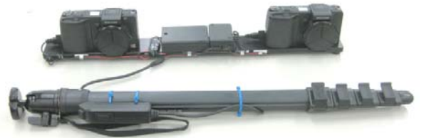
図4 試作ステレオ撮影装置
