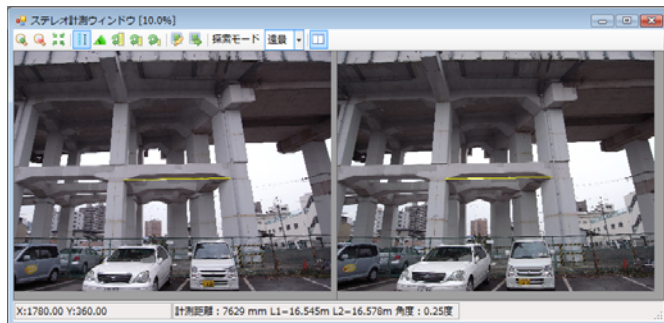
図5 部材寸法測定時のシステム画面
