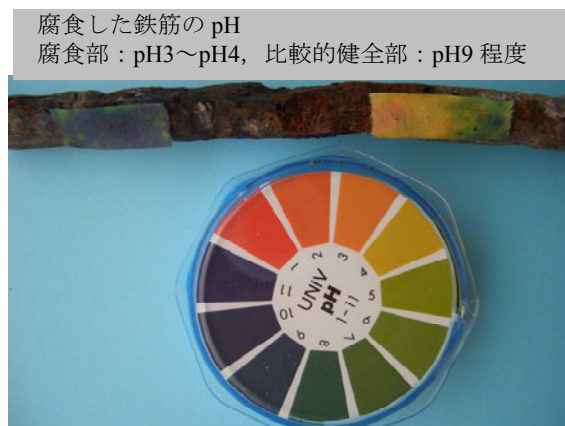
図-6 腐食した鉄筋の pH
