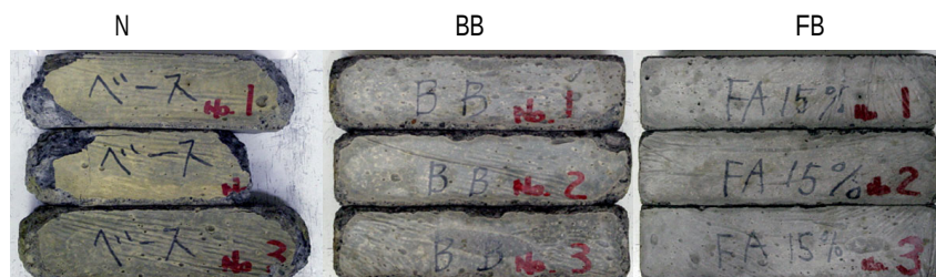
写真-1 硫酸ナトリウム 10%溶液浸せき 104 週後の供試体状況
