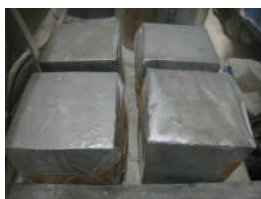
D ビニールシート養生
