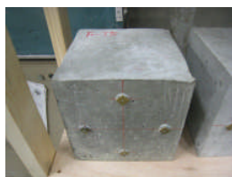
F 被膜養生剤塗布
