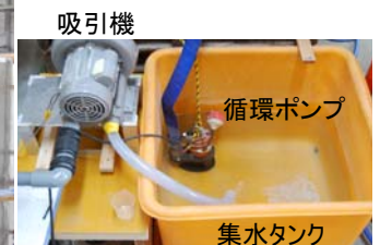
写真1 浸水養生工法
