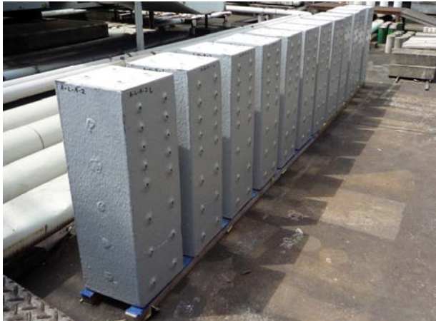
写真-1 屋外暴露状況（暴露条件：通常（雨掛有））
